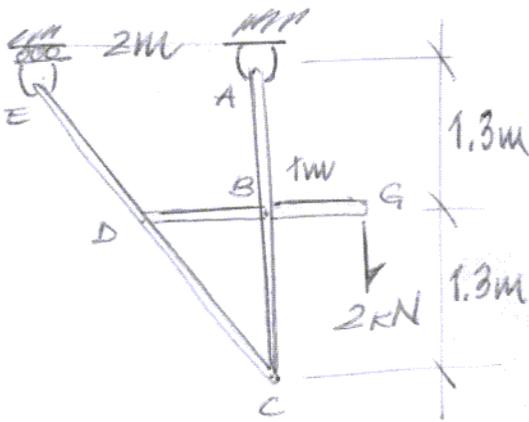
Calcular las reacciones en la BARRA DBG en el bastidor
